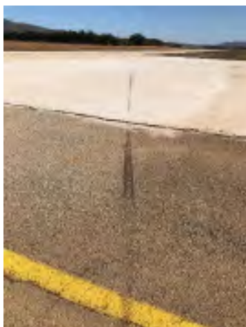
Ilustración 8: Huellas de la trayectoria de la aeronave en la salida H1 y en la plataforma de estacionamiento
