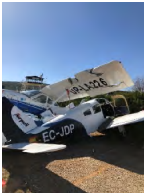
Ilustración 10: Detalle de cómo quedó la aeronave tras impactar con otras dos aeronaves y un seto
