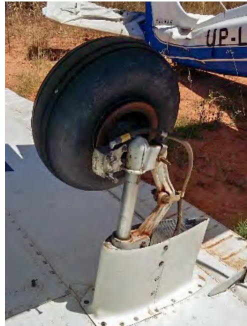
Ilustración 12: Detalle del depósito (fotografía izquierda) y de las tuberías (fotografía derecha) de hidráulico del sistema de frenos
