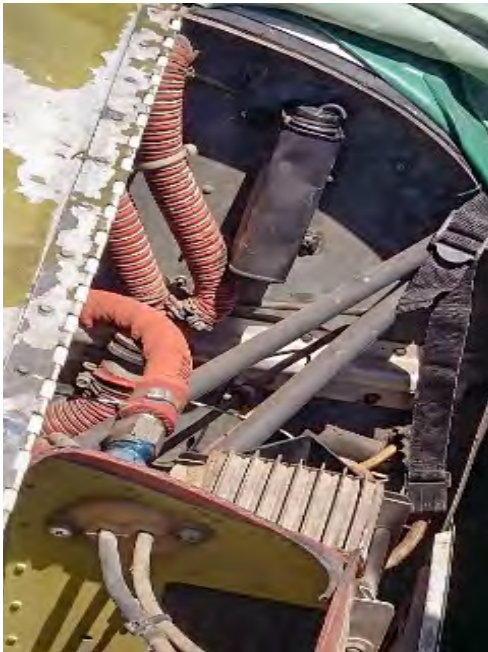
Ilustración 12: Detalle del depósito (fotografía izquierda) y de las tuberías (fotografía derecha) de hidráulico del sistema de frenos
