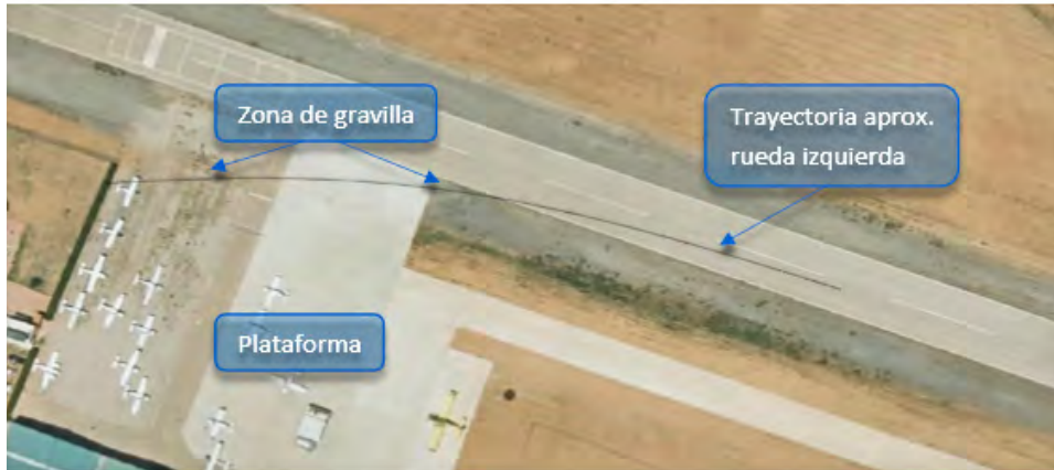
Ilustración 11: Trayectoria aproximada de la rueda principal izquierda
