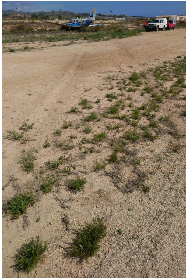
Fig.1: Recorrido y huellas de la aeronave a la izquierda de la pista.
