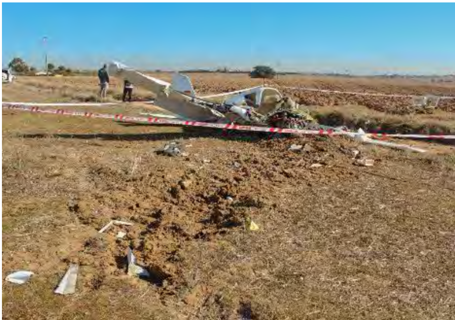
Fig.3: Socavón y restos de la aeronave EC-NAM
