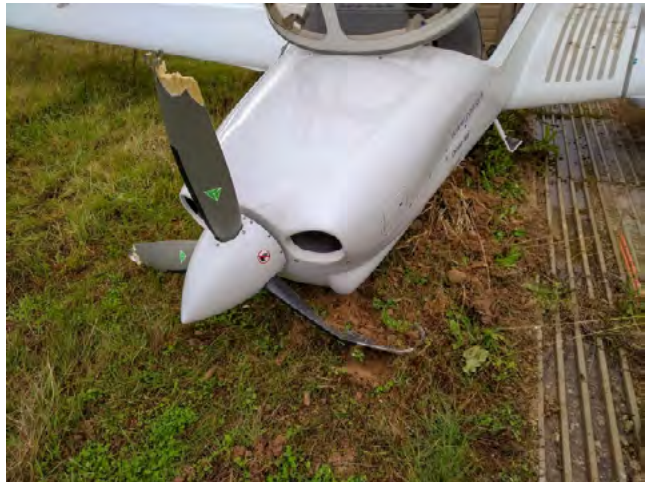
Figura 4. Daños en las palas de la hélice
