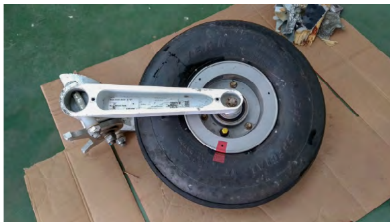
Figura 5. Daños en la rueda delantera del tren
