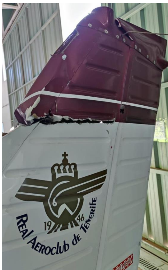
Daños en el estabilizador vertical de la aeronave
