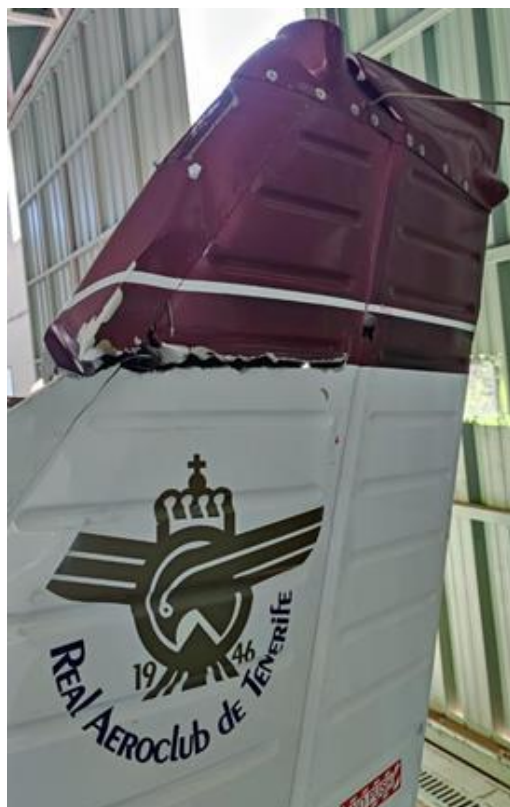
FIG. 5 DAÑOS EN EL ESTABILIZADOR VERTICAL
