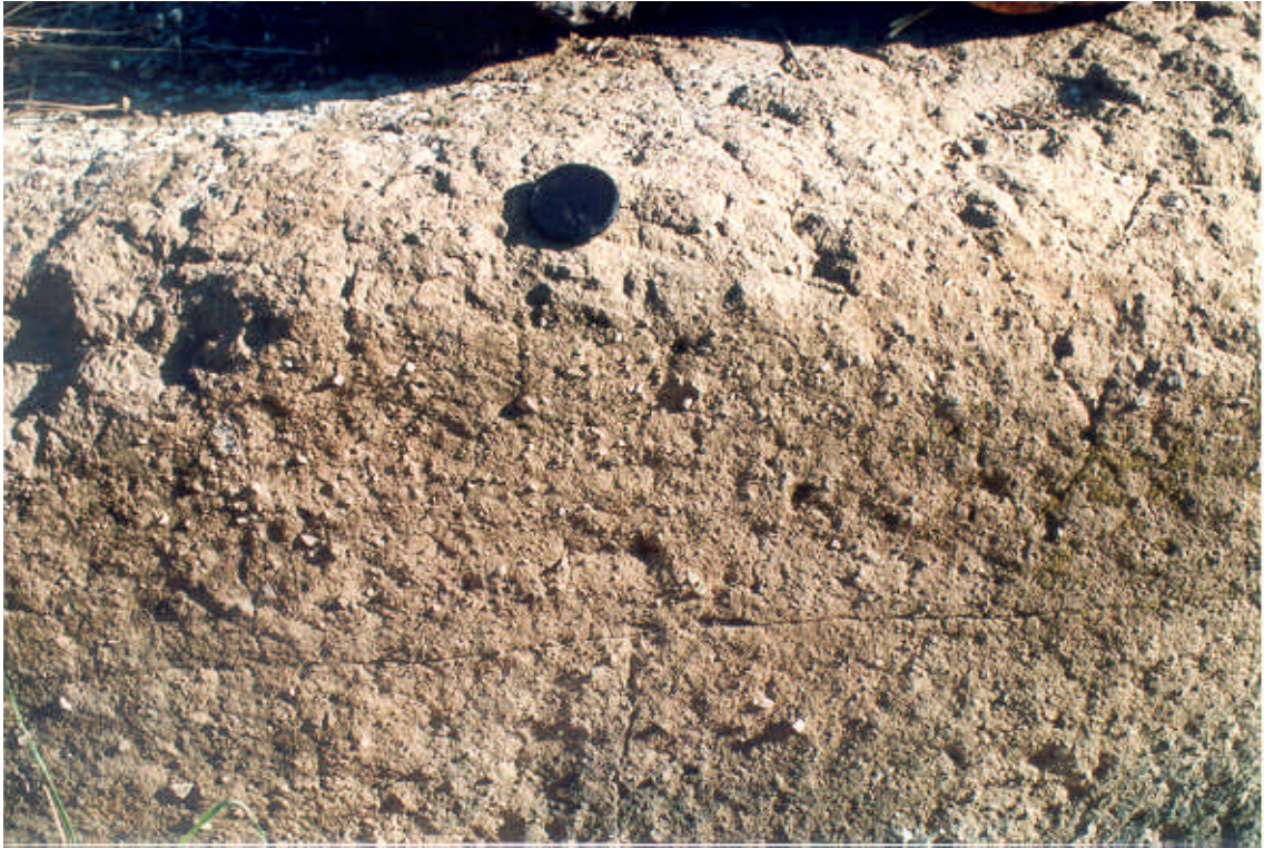
Foto 13. Materiales fragmentarios de origen volcánico, hidromagmático, pertenecientes al grupo litológico (001c). Pk (290) de la carretera nacional 430.
