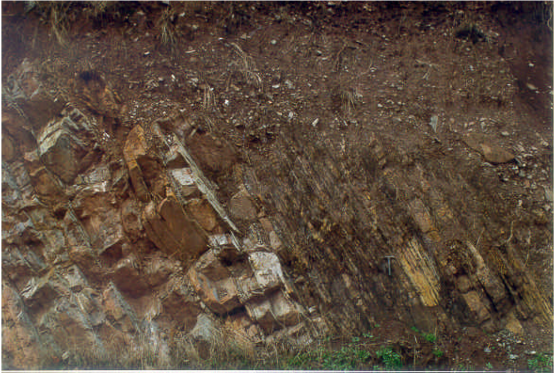
Foto 48. Pizarras y rocas volcánicas pertenecientes al grupo litológico (122b). pk(243) de la carretera nacional 430.
