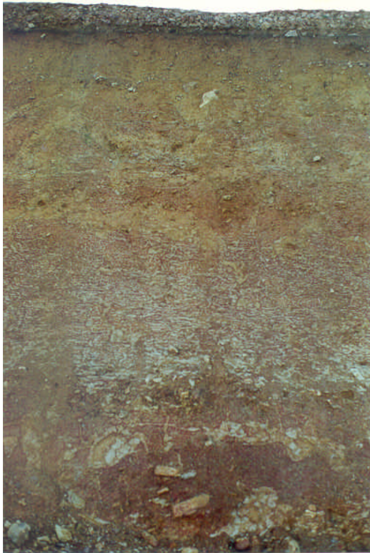
Foto 41. Perfil litológico del manto de alteración constitutivo del grupo (V), en el que se pueden observar los diferentes estadios evolutivos de este tipo de suelos. Puerto de las Peñas Pardas, pk(34) de la carretera nacional (430).
