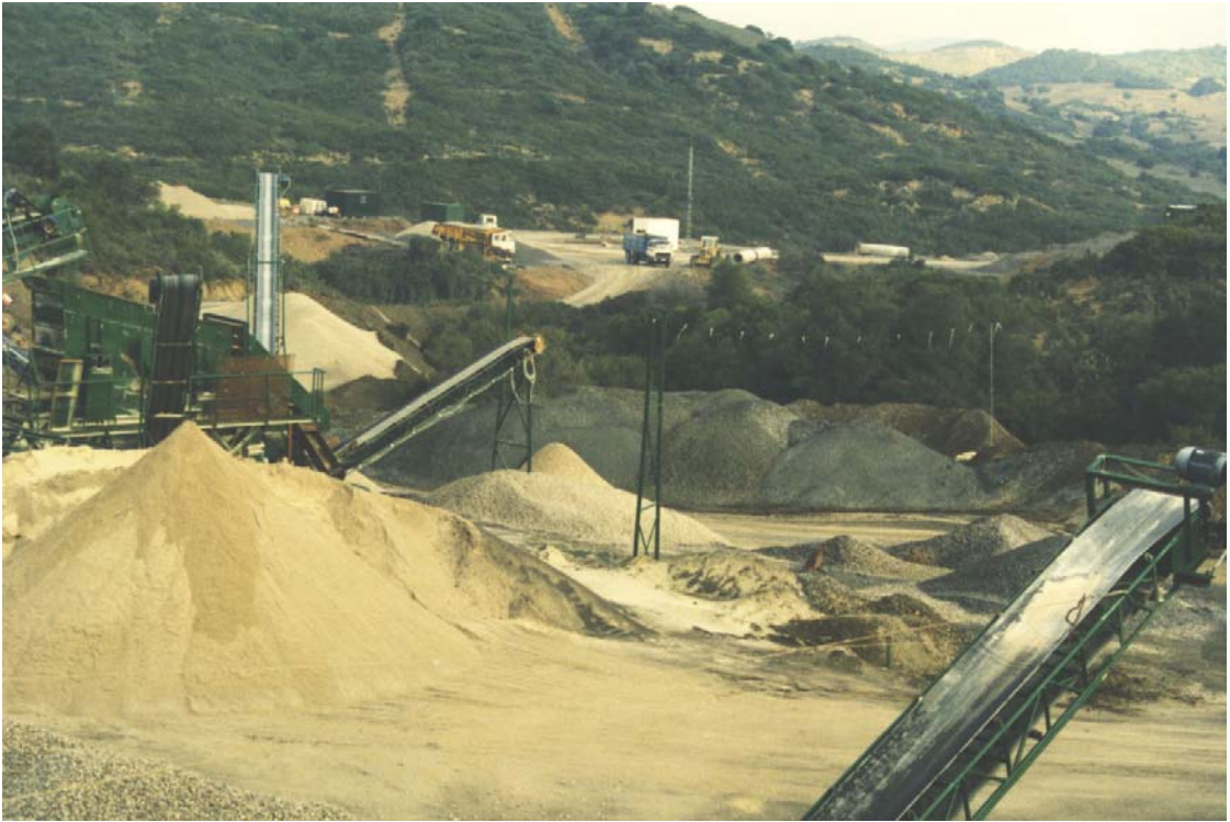
Figura 5.5. Visión general de la planta de clasificación de áridos de la cantera correspondiente al YR-22. Pueden observarse los áridos de ofita (oscuros) y de dolomía (claros). Proximidades al p.k. 45 de la carretera C-440 (Hoja 1070-4).
