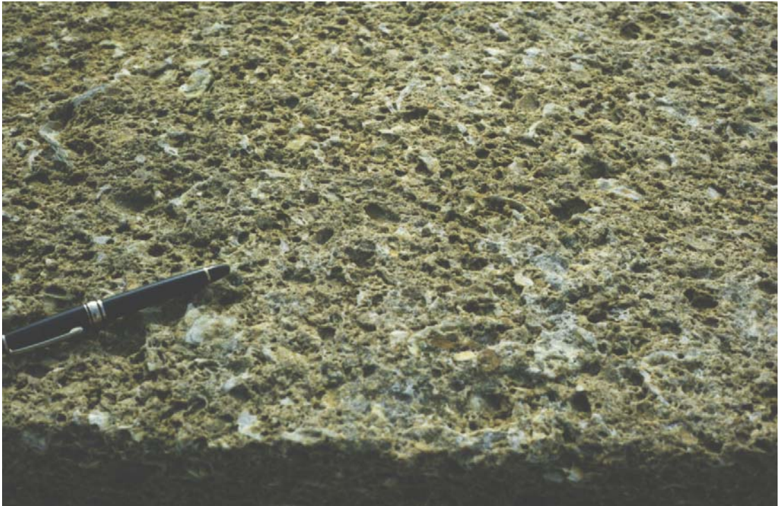
Figura 3.23. Aspecto de detalle de la facies "ostionera", en un bloque dedicado a la construcción, en el que puede observarse a gran abundancia de restos de conchas que le dan el aspecto característico.
