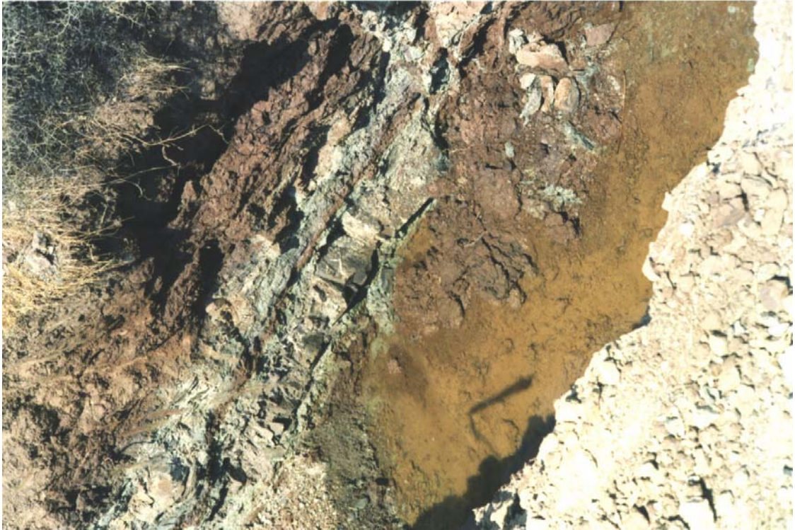
Figura 3.80. Aspecto de las arcillas con una intercalación de arenisca micácea del grupo (313b), en una excavación realizada en la carretera de Facinas (Hoja 1074-2).
