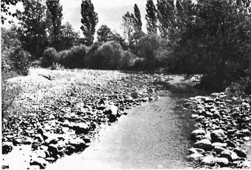
Foto 49.— Aluvial del río Trueba (Estación 104). Grupo A1. Gravas lavadas con cantos y bolos subsféricos, de caliza y arenisca, con arena en proporción variable aunque generalmente minoritaria.
