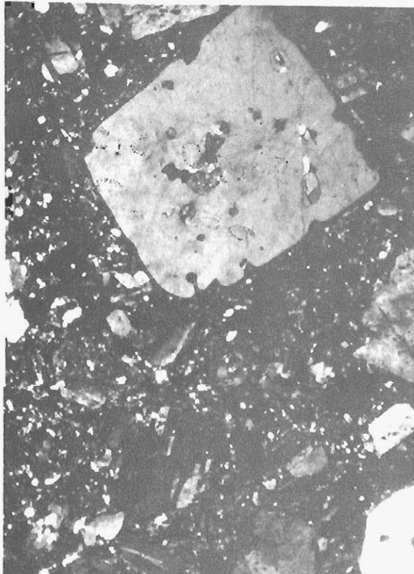
Foto 3.33.— Aspecto de otra de las preparaciones microscópicas del pórfido granítico.
