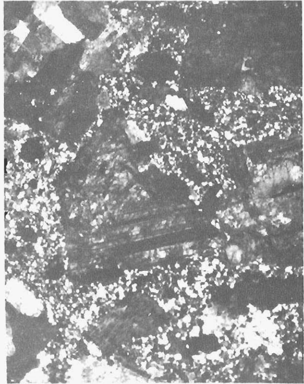
Foto 3.32.— Aspecto microscópico de una de las preparaciones de pórfido granítico.
