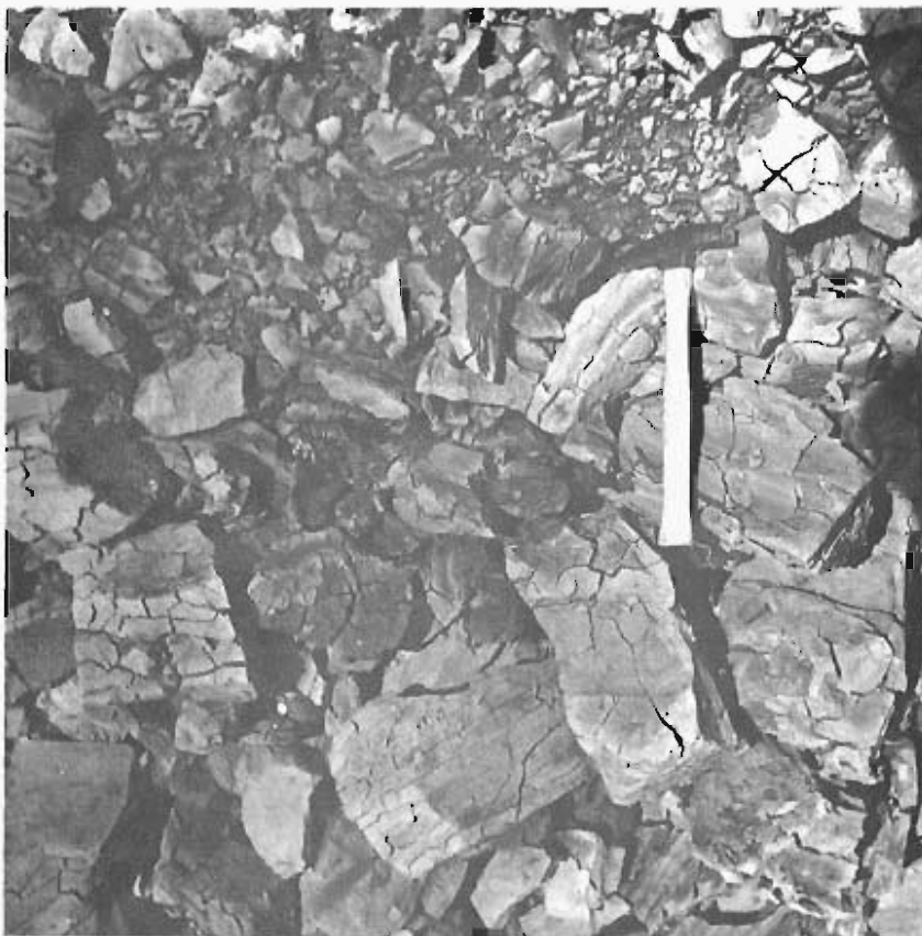
Foto 9.— Detalle de los limos arcillosos (322a) egrietados, al Sureste Vélez—Málaga.
