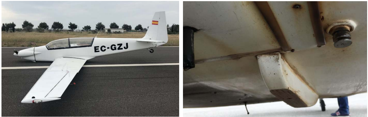
Ilustración 3: Detalle de cómo quedó la aeronave tras el incidente (fotografía izquierda) y de los patines situados en la parte inferior del fuselaje (fotografía derecha)
