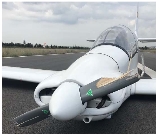
Ilustración 1: Detalle de la hélice tras el incidente
