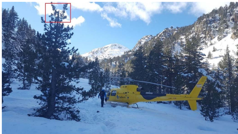
Figura 6. Fotografía de la aeronave en el punto de toma. Señalado con un cuadrado rojo en árbol con el que impactó
