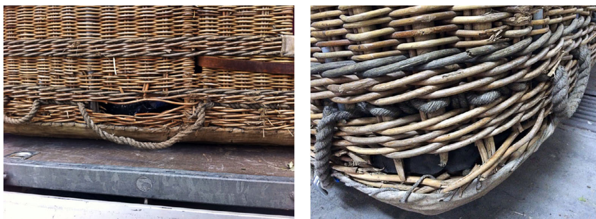
Figura 2. Daños en la barquilla
