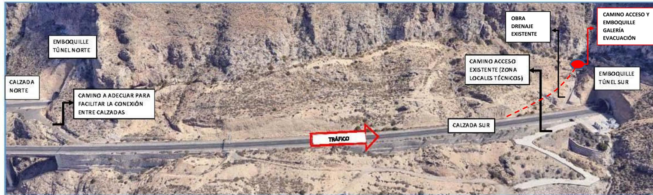
*Detalle de la calzada Sur en la que se dispone el camino de acceso a la galería de evacuación subterránea dispuesta entre ambos túneles*
