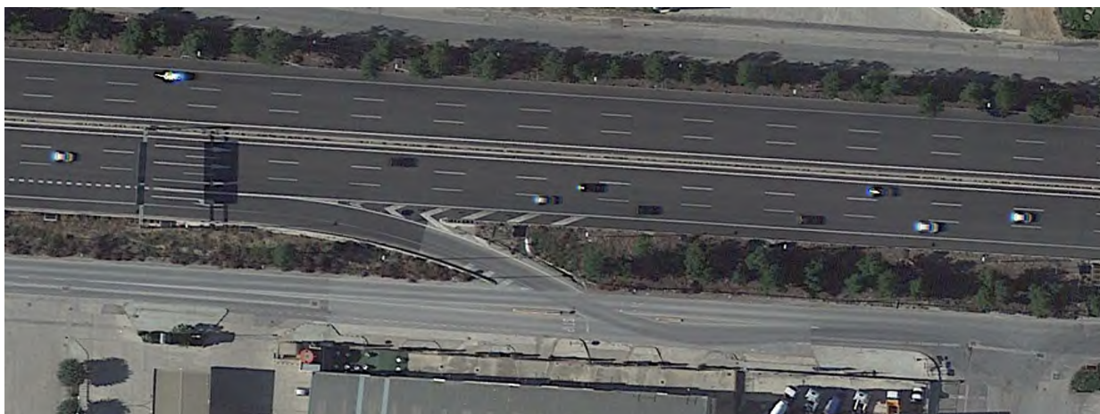
Figura 2. Salida del tronco de la autovía hacia la vía de servicio bidireccional de la margen derecha, a la altura del p.k. 343+100
