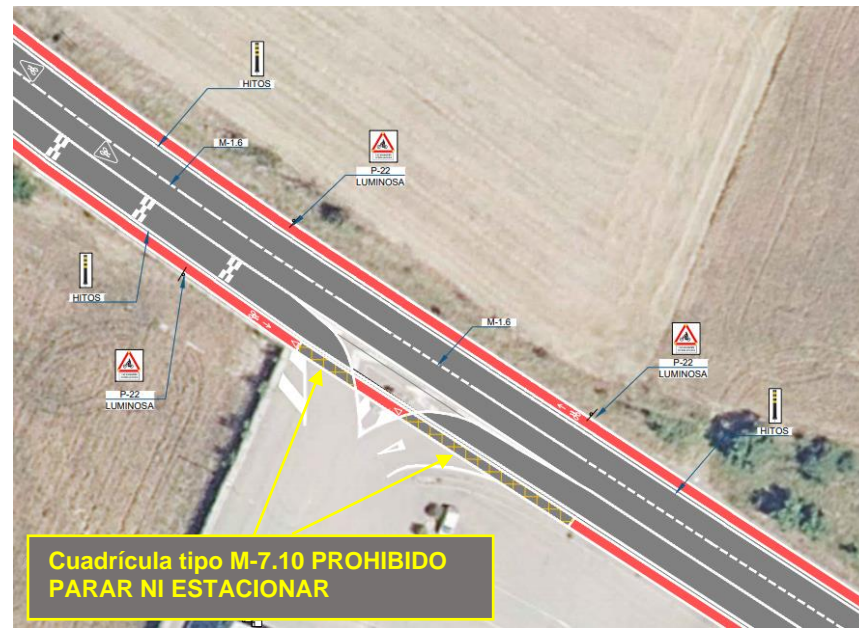
Vista en planta del carril bici a su paso frente al acceso de la E.S. en Rescanato.
