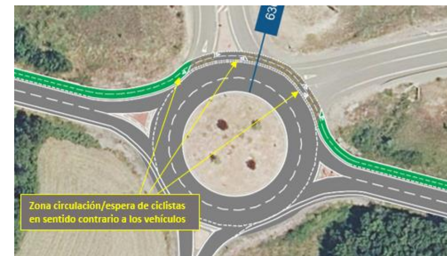
Vía ciclista bidireccional cruzando la glorieta de enlace con A-23 por el lado norte.
