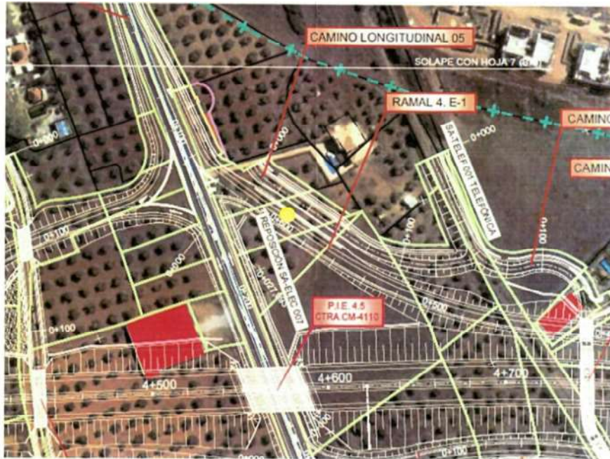
TANTO EL RAMAL 4. E-1 Y EL CAMINO LONGITUDINAL 05 PASAN POR ENCIMA DE LA FOSA SÉPTICA .
