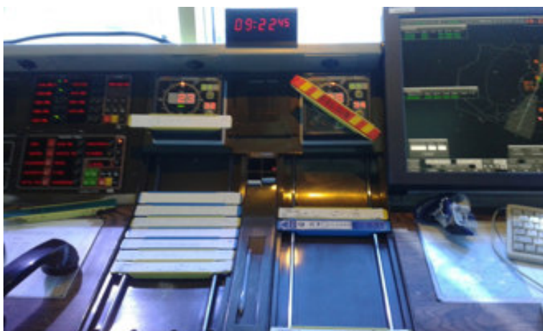
Figura 5. Ayudas visuales para pista cerrada en la posición de LCL GCLP
