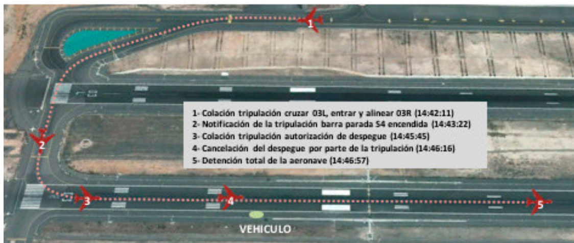
Figura 3. Gráfico velocidades de la aeronave GMI6129 carrera de despegue
