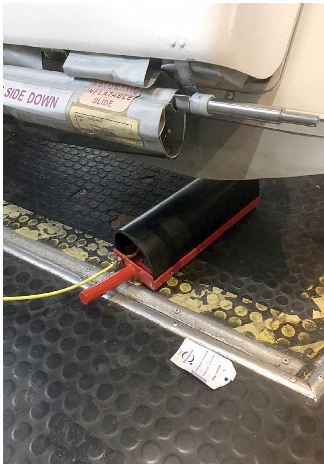
Figura 2. Posicionamiento de la zapata de seguimiento entre la puerta y el piso de la pasarela
