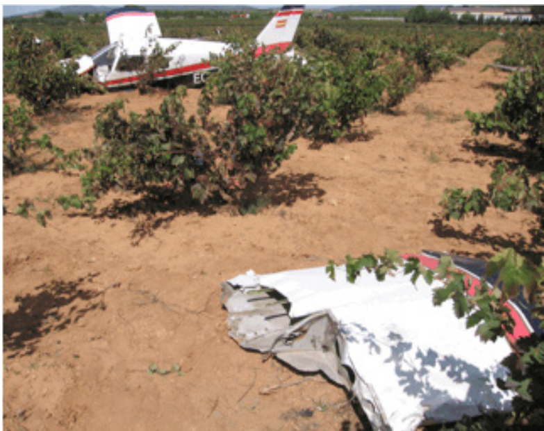
Figura 2. Extremo del plano izquierdo desprendido y posición relativa a la aeronave
