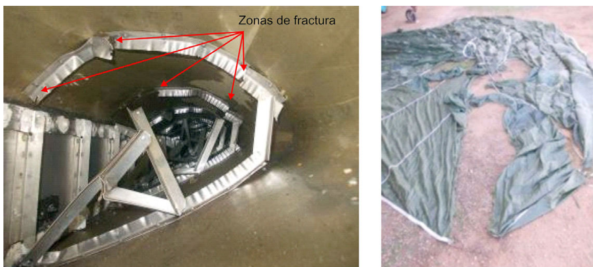
Figura 2. Fotografías del interior del plano izquierdo y del paracaídas
