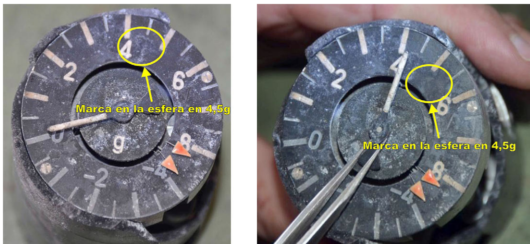
Figura 12. Marcas en la esfera del indicador de aceleración vertical
