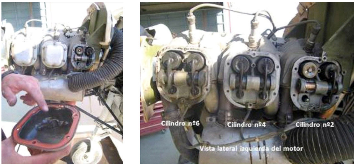
Figura 5. Desmontaje de las tapetas de los cilindros 2, 4 y 6 y estado de balancines
