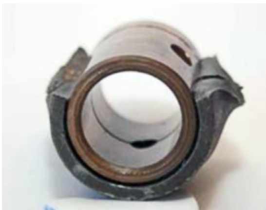
Figura 8. Desalineación de los orificios de lubricación
