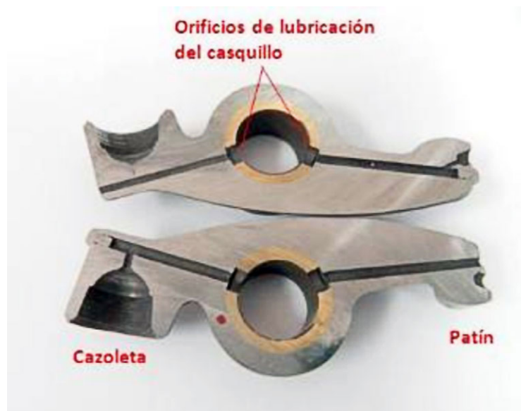
Figura 4. Detalle del corte de uno de los balancines mostrando el sistema de lubricación
