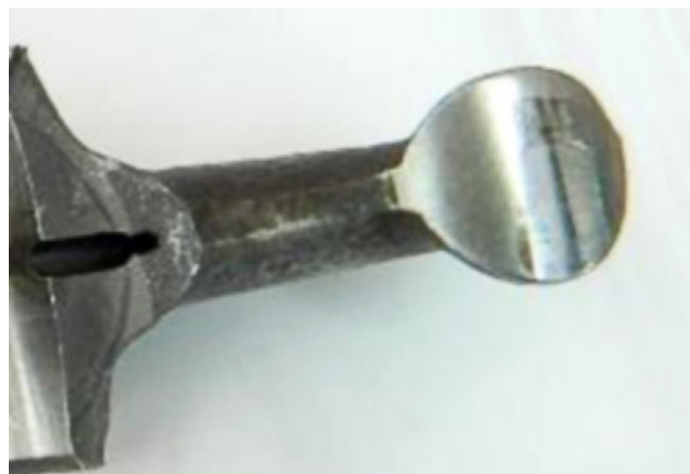
Figura 9. Planos de contacto del patín del balancín de escape dañado
