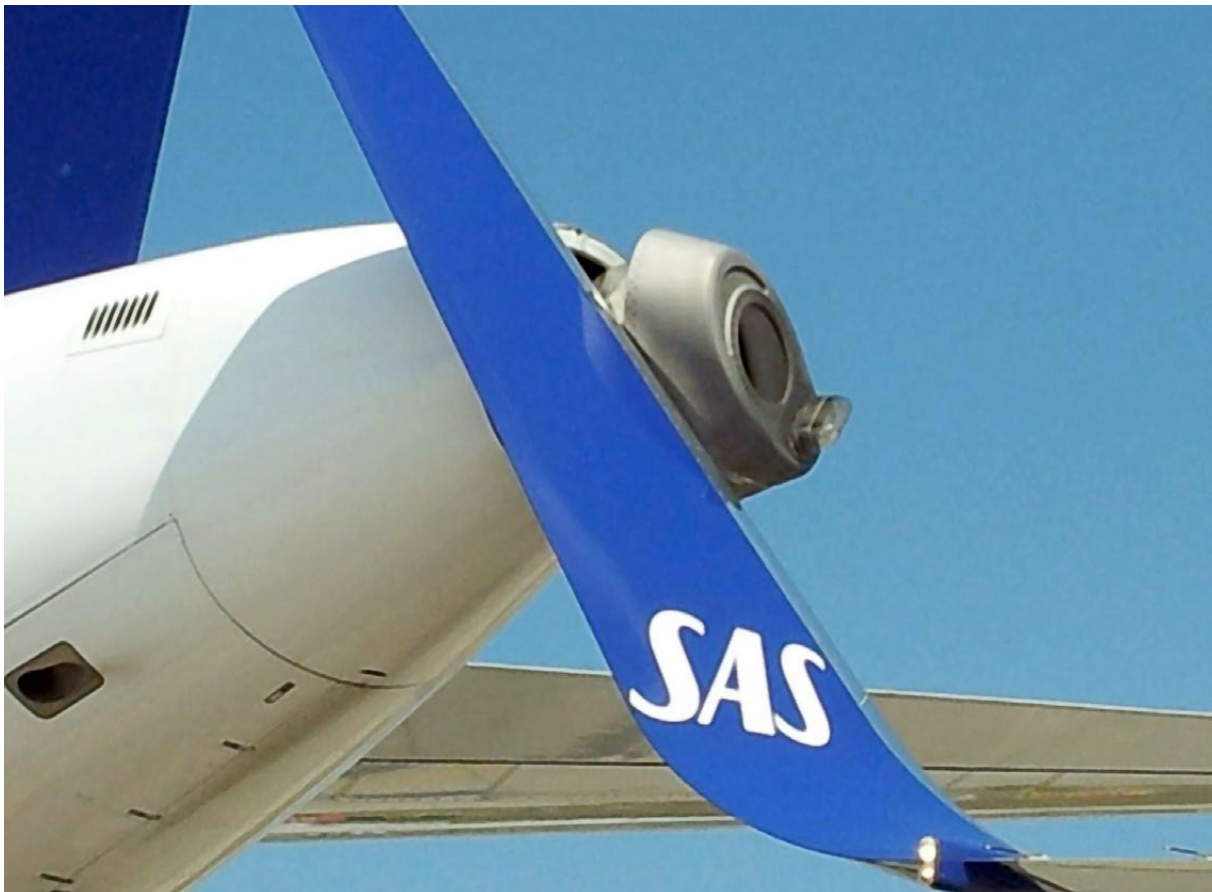
Figura 1. Fotografía del «winglet» del B-737 enganchado a la tobera de salida de gases del APU del A320
