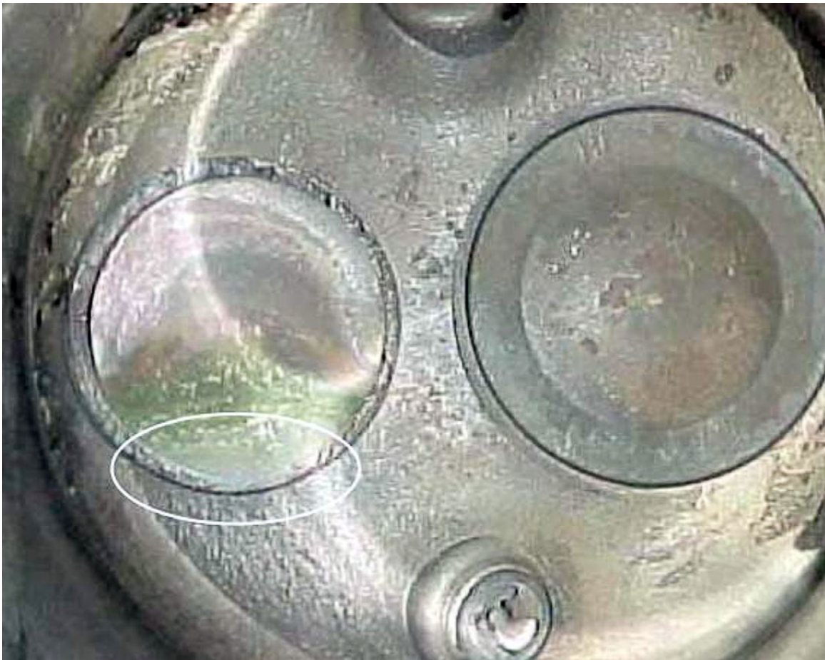
Figura 7. Fotografía extraída del SB 03-03 de TCM. Muestra de válvula de escape quemada con signos de fuga y daño
