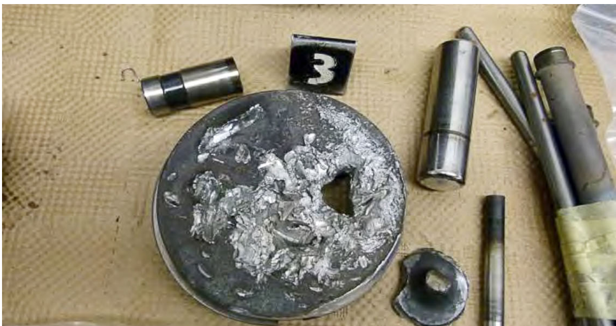
Figura 5. Pistón, válvula y otros elementos del cilindro n.º 3
