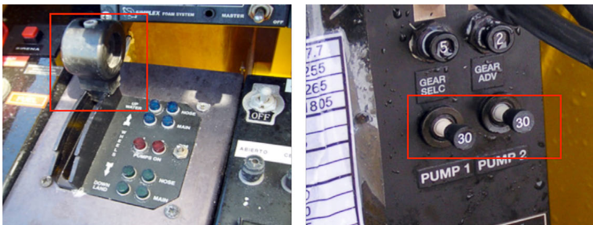
Figura 2. Posición de la palanca de tren en UP y disyuntores de las bombas del tren saltados
