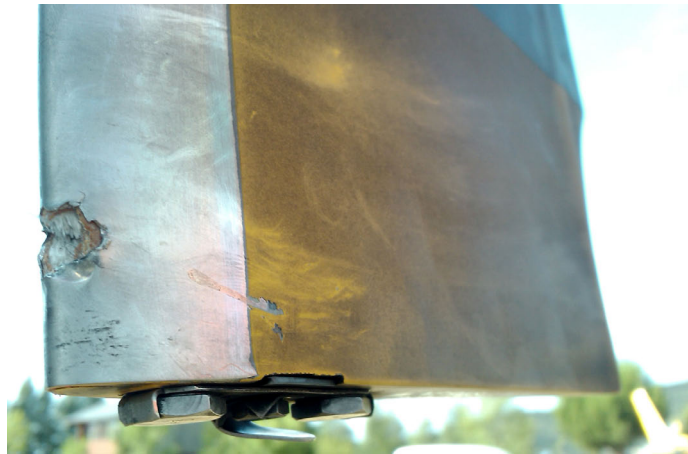
Figura 1. Daños en una de las palas
