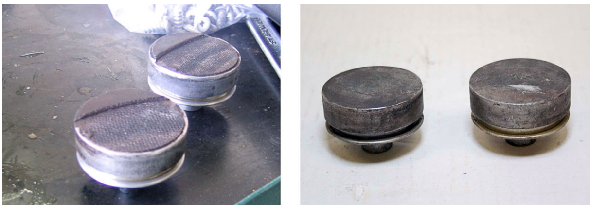
Figura 8. Pistones del conjunto de frenos 30-83 con aislante sobre su superficie (derecha) y pistones del conjunto 30-65 sin aislante instalados en el freno izquierdo de la aeronave (izquierda)
