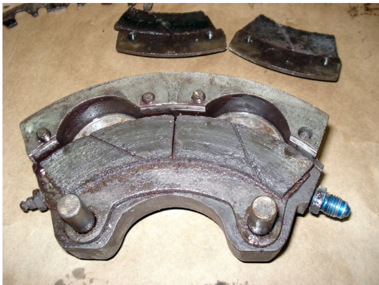
Figura 5. Pastillas de freno del conjunto de freno izquierdo instaladas en la aeronave
