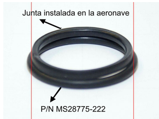
Figura 7. Comparativa de junta instalada y junta de diseño con número de pieza MS28775-222
