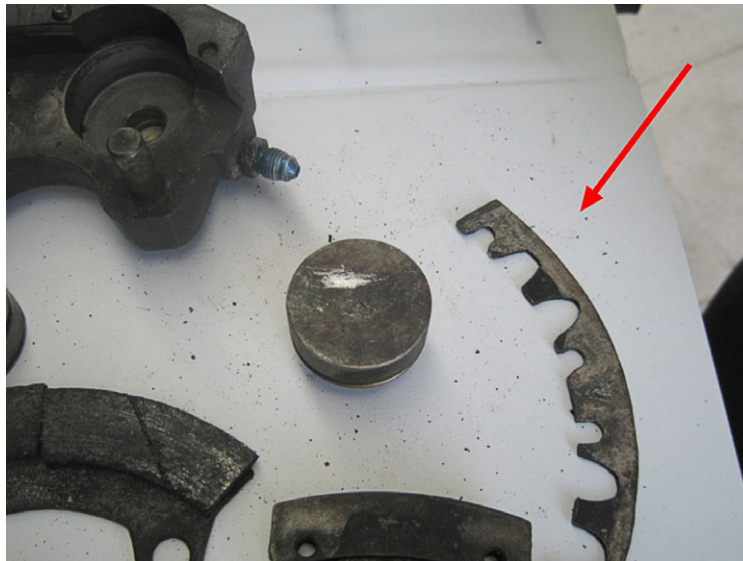
Figura 9. Pieza metálica que sustituye al aislante térmico (a la derecha)
