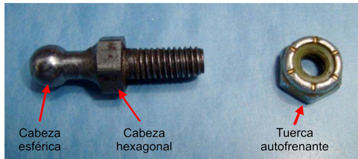
Figura 2. Tornillo de fijación del cable del mando de gases al carburador
