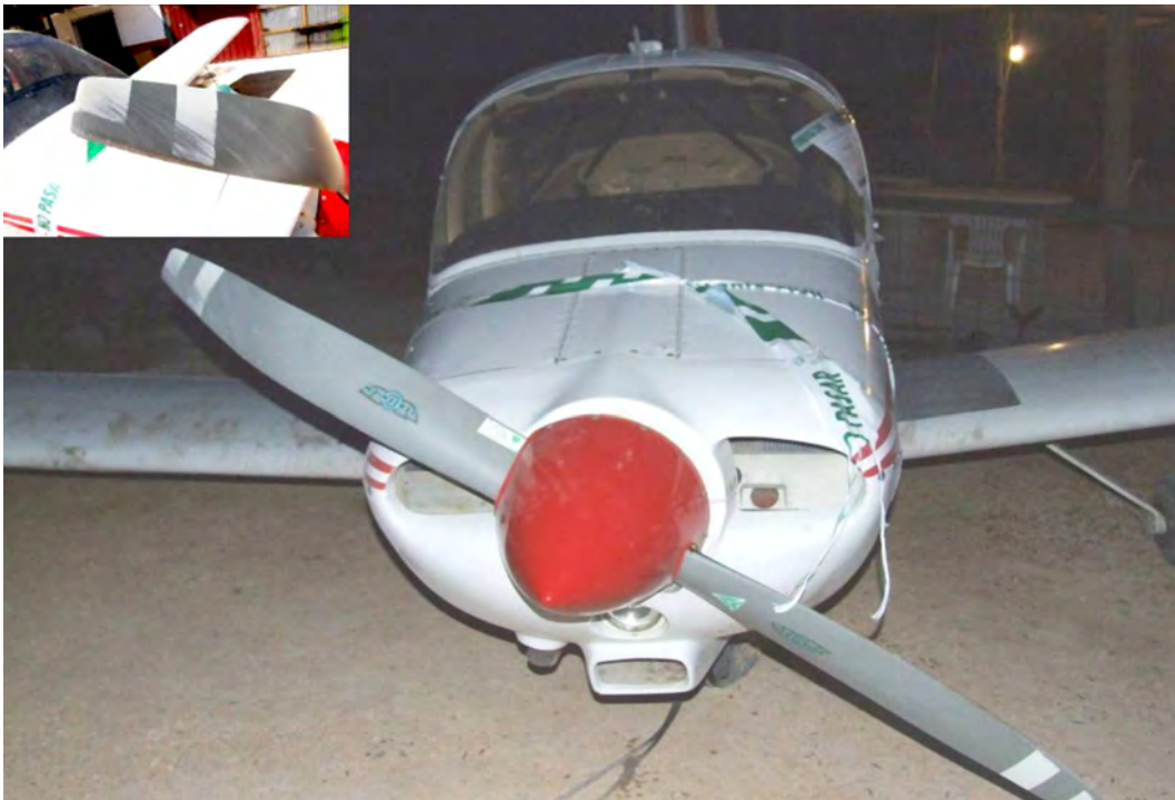
Figura 4. Fotografía de la hélice y detalle de la pala dañada
