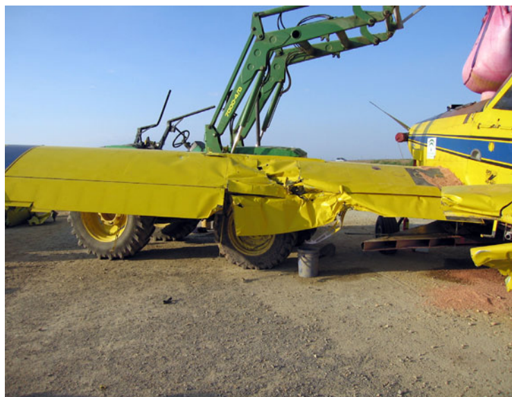
Figura 2. Daños en el plano izquierdo de la aeronave EC-HFJ y en el tractor
