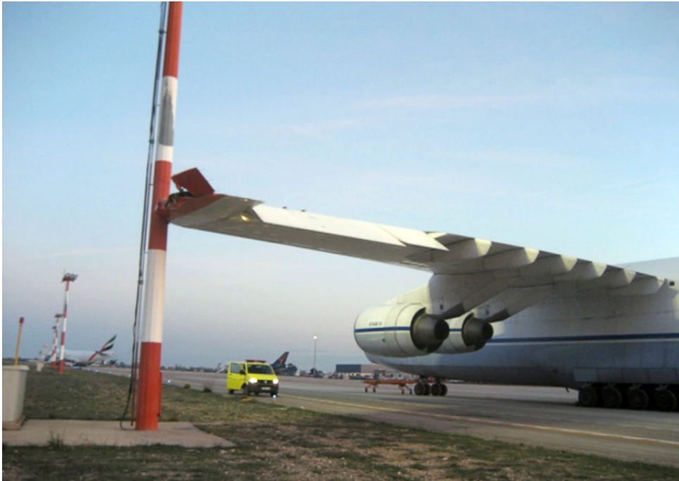
Figura 2. Daños sufridos por la aeronave
