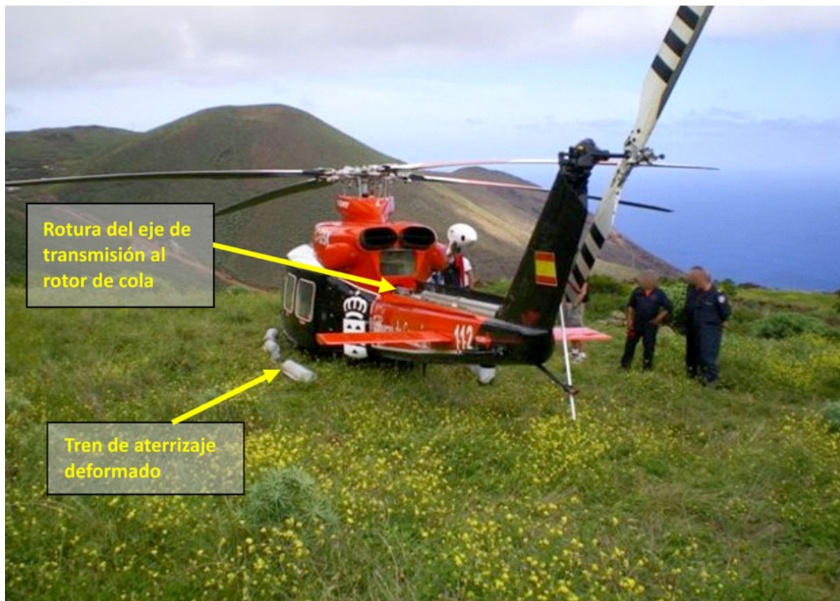
Figura 1. Daños en el helicóptero
