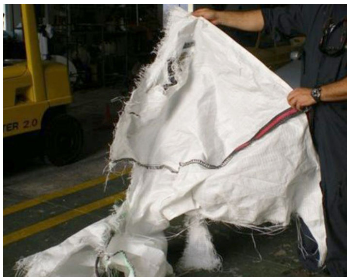
Figura 2. Saco de rafia roto y localizado en el rotor de cola
