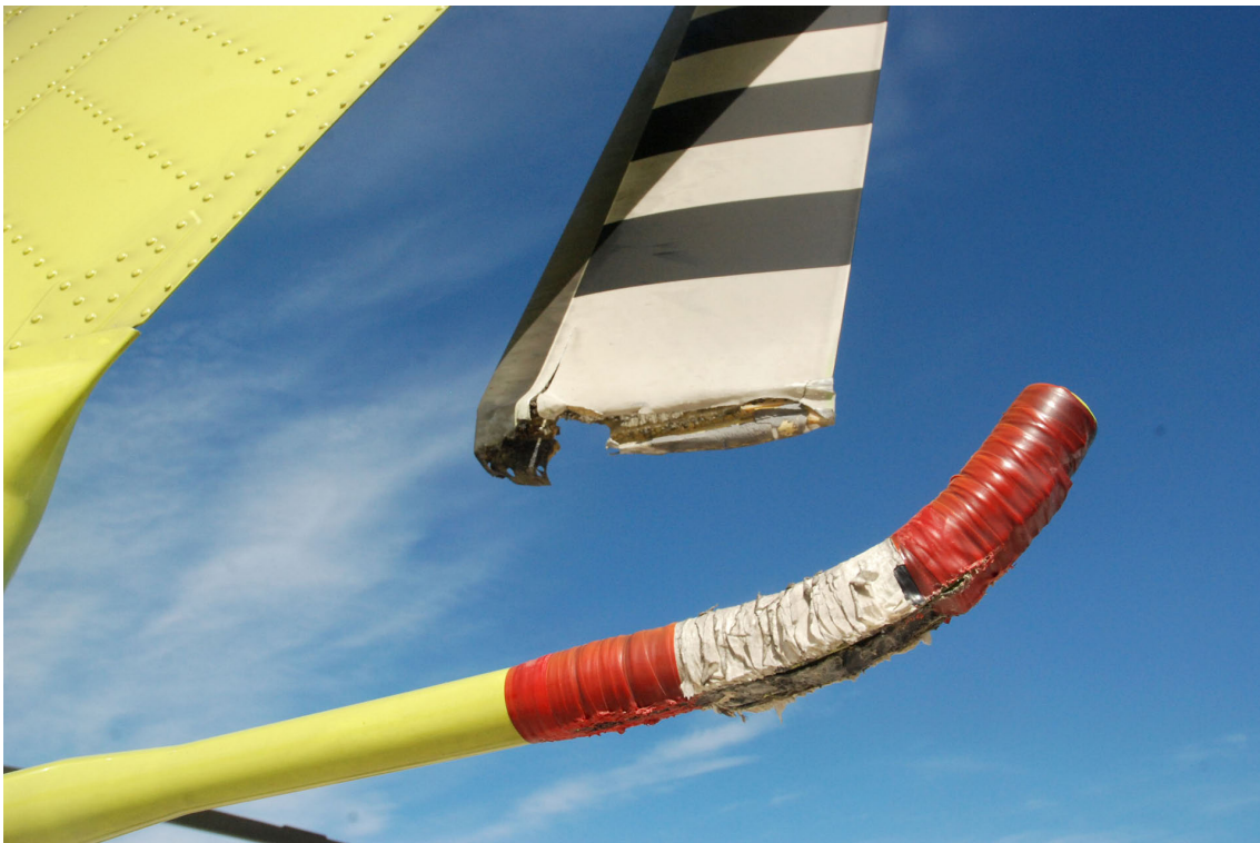
Figura 2. Daños en protector y rotor de cola.
