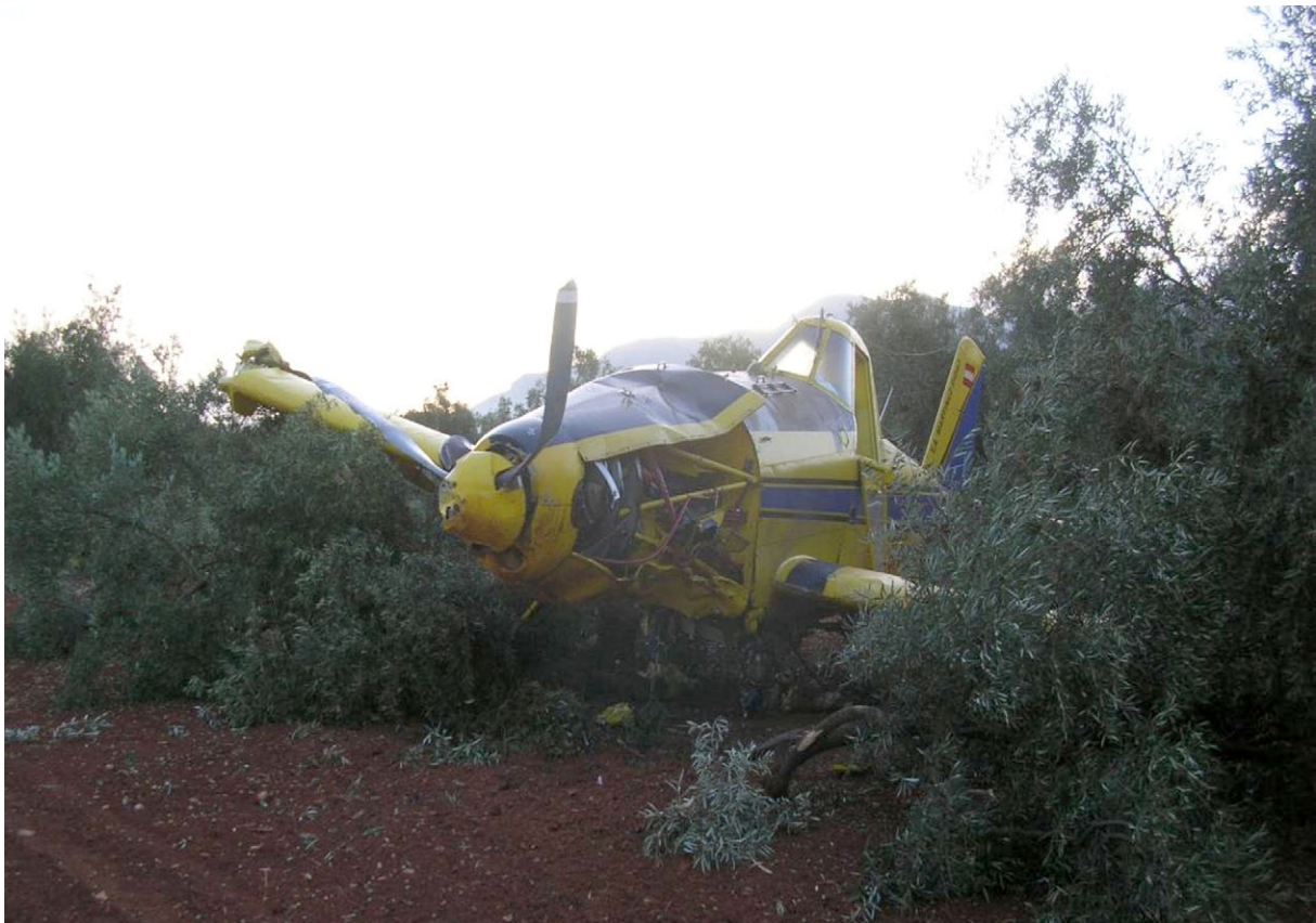
Figura 2. Estado final de la aeronave, ausencia de una pala de la hélice
