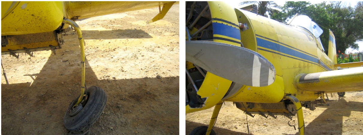
Figura 2. Daños en la pata izquierda y en la hélice
