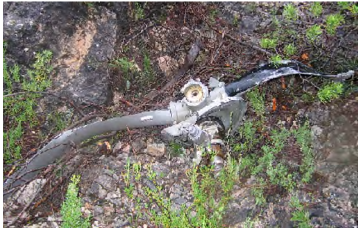
Figura 4. Resto del buje de hélice con dos palas
