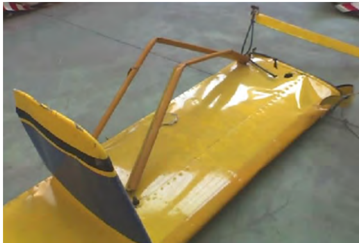
Figura 5. Restos del estabilizador horizontal izquierdo
