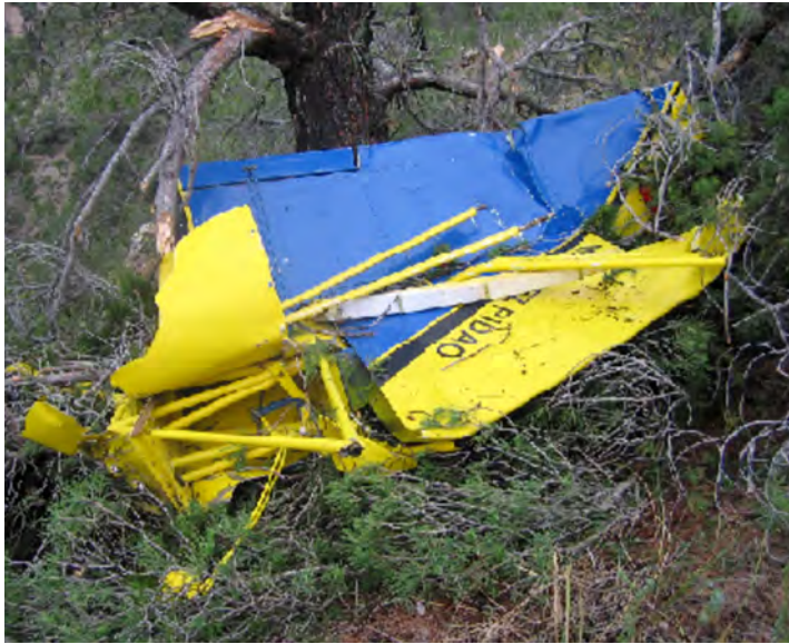
Figura 6. Restos de deriva y fuselaje posterior
