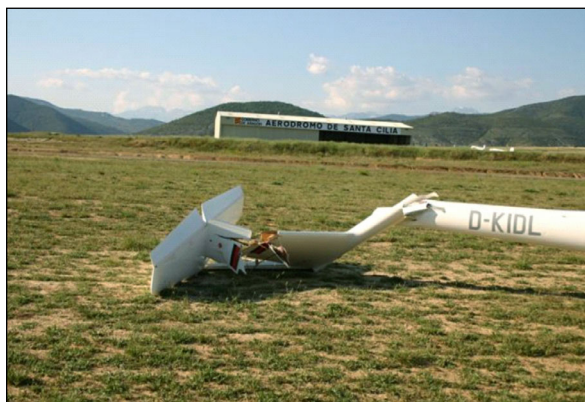
Figura 1. Daños en la aeronave D-KIDL
