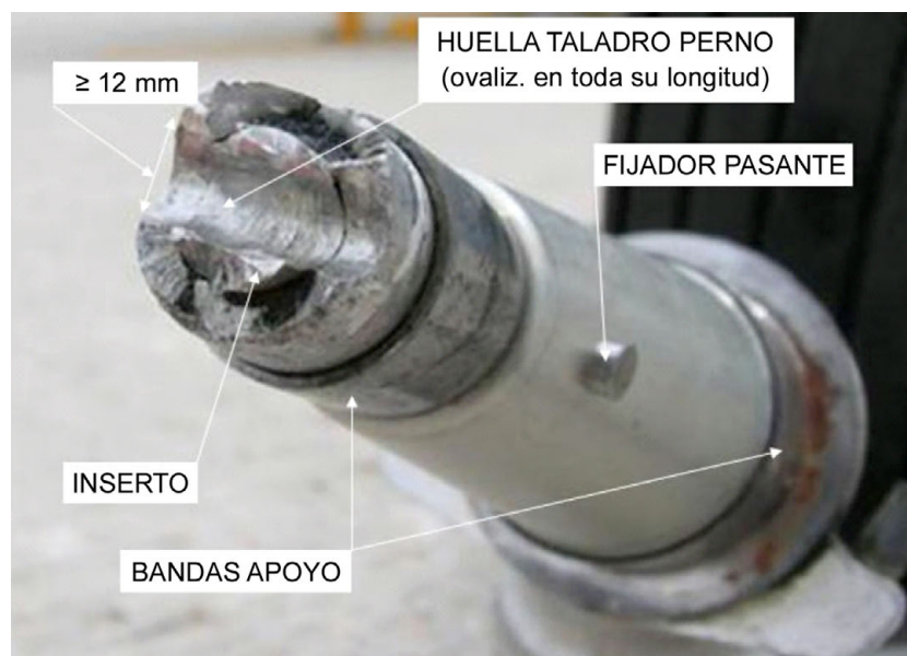
Figura 5. Vista del vástago y su rotura
