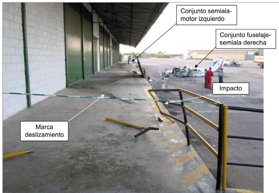
Figura 1. Situación general de los restos
