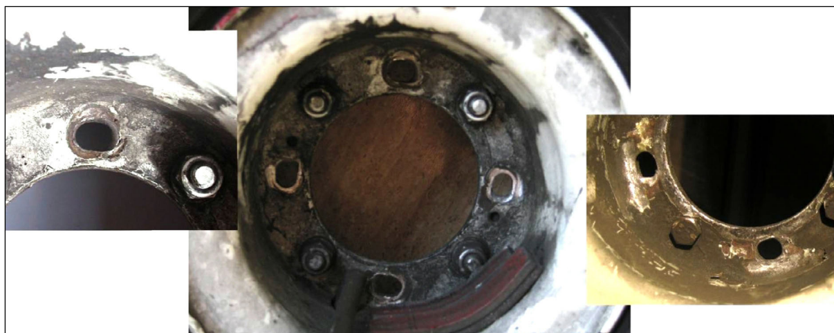
Foto 3. Detalles de la deformación de los orificios en la llanta
