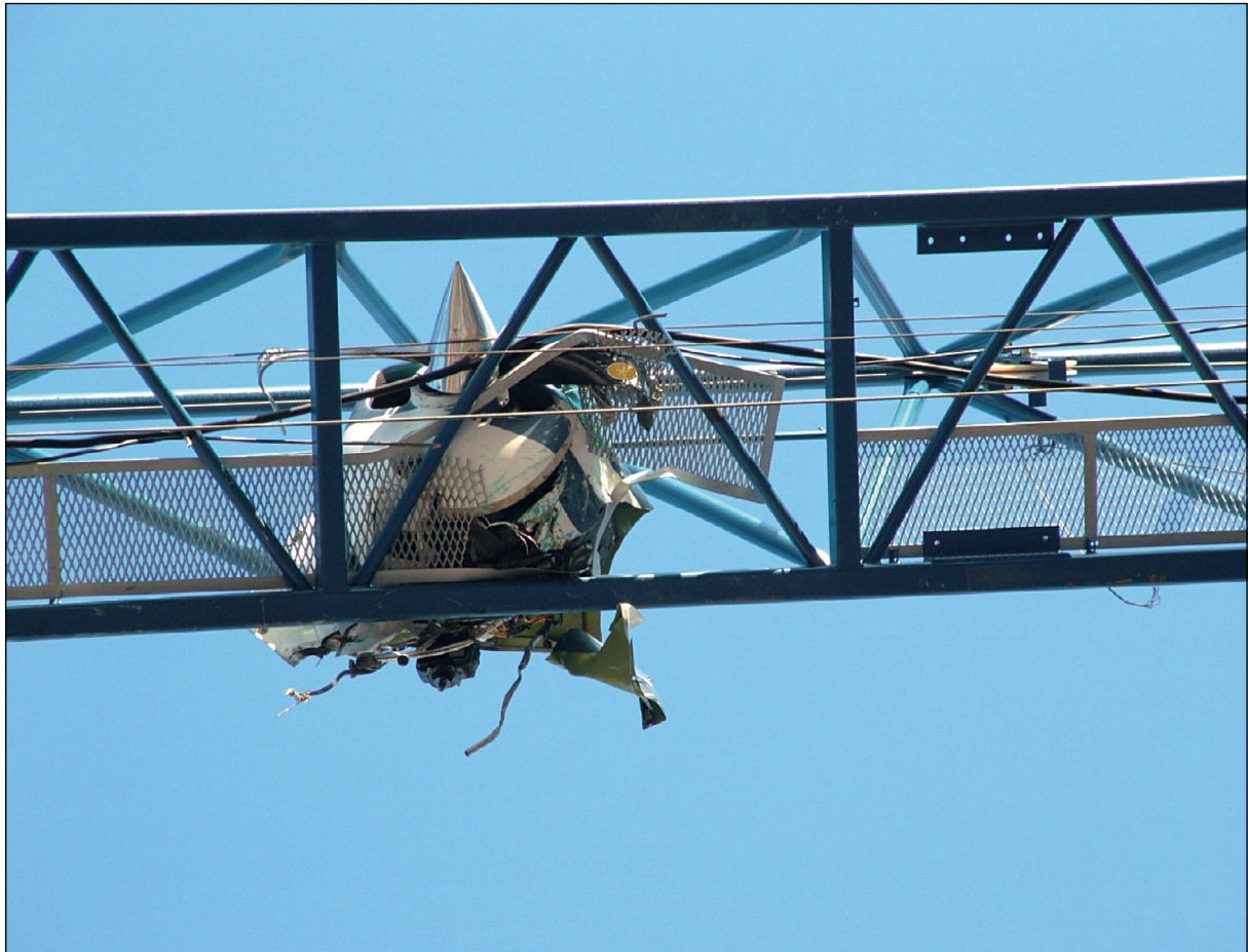
Figura 1.4. Vista de los restos del grupo motopropulsor incrustados en la estructura de la grúa
