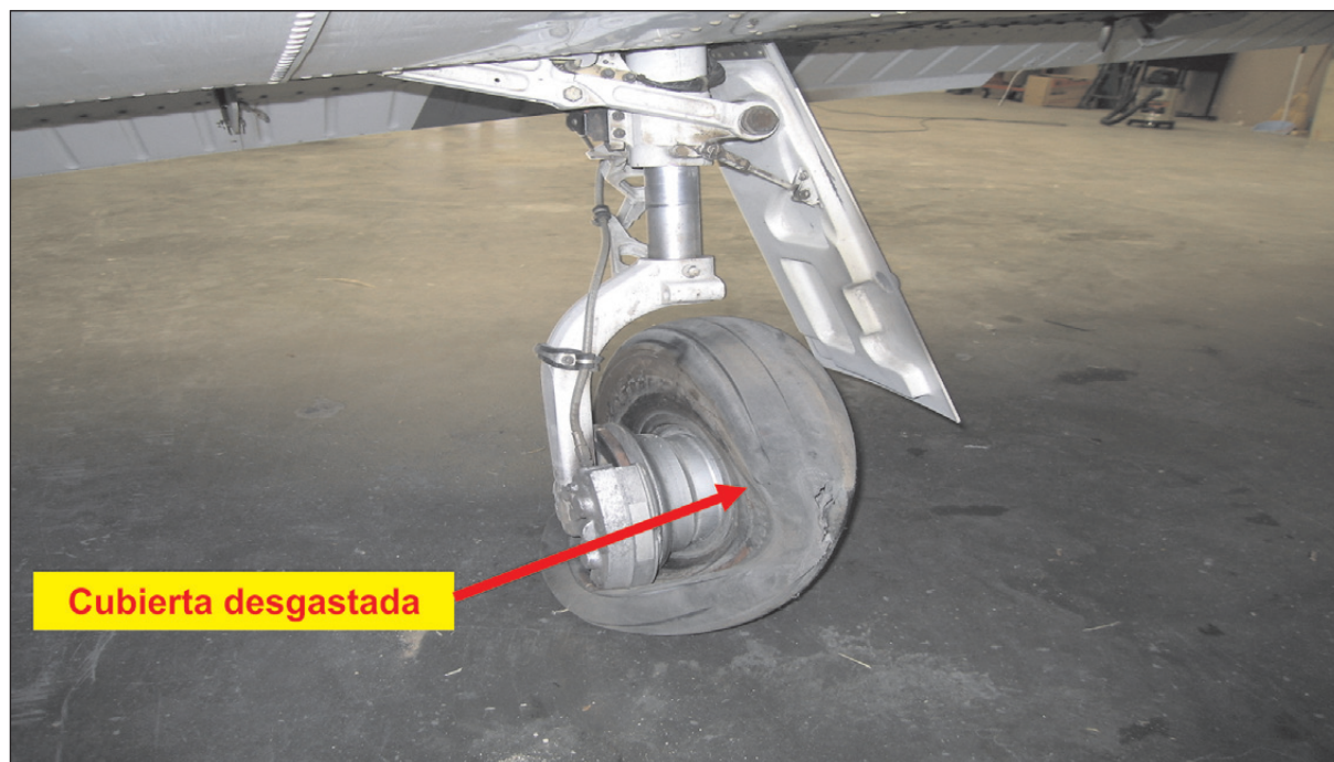
Figura 2. Daños en la pata izquierda
