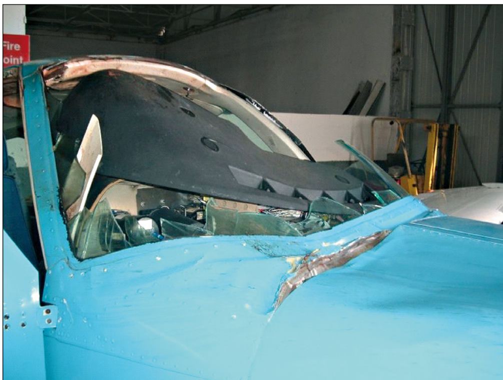
Figura 1. Daños del impacto del ave en la aeronave
