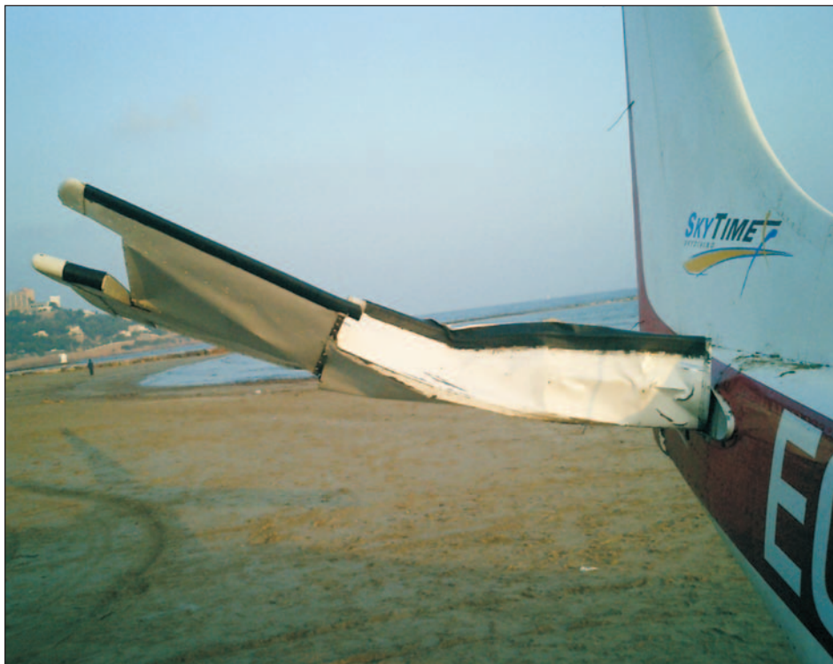
Foto 2. Detalle de daños en estabilizador horizontal derecho
