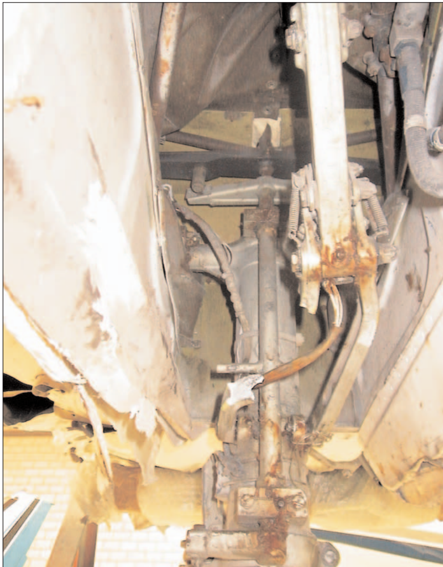
Figura 3. Brazos de arrastre del tren de morro (vista desde la parte posterior del tren)
