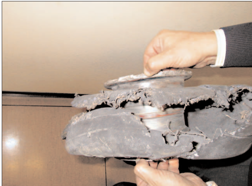
Figura 4. Daños producidos por la llanta
