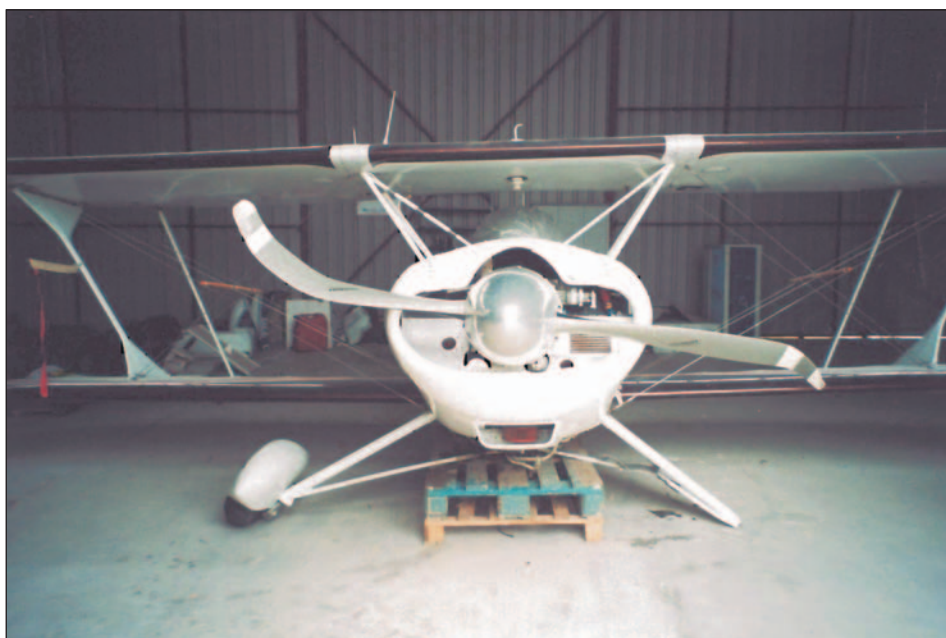
Figura 2. Daños sufridos por la aeronave
