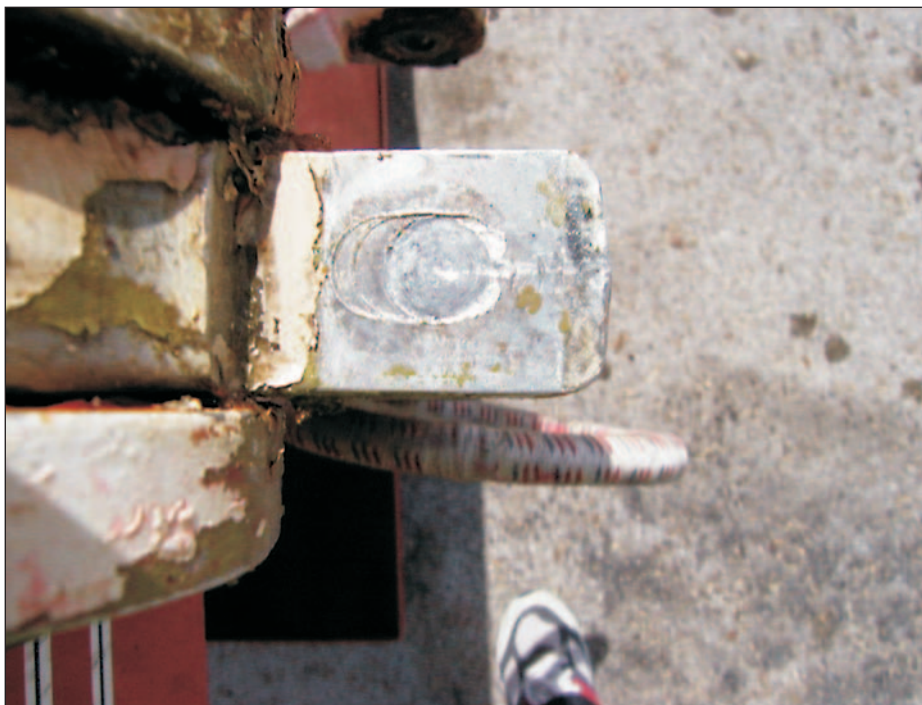
Figura 5. Marcas producidas en el brazo de arrastre inferior por la cabeza del vástago P/N ED12439
