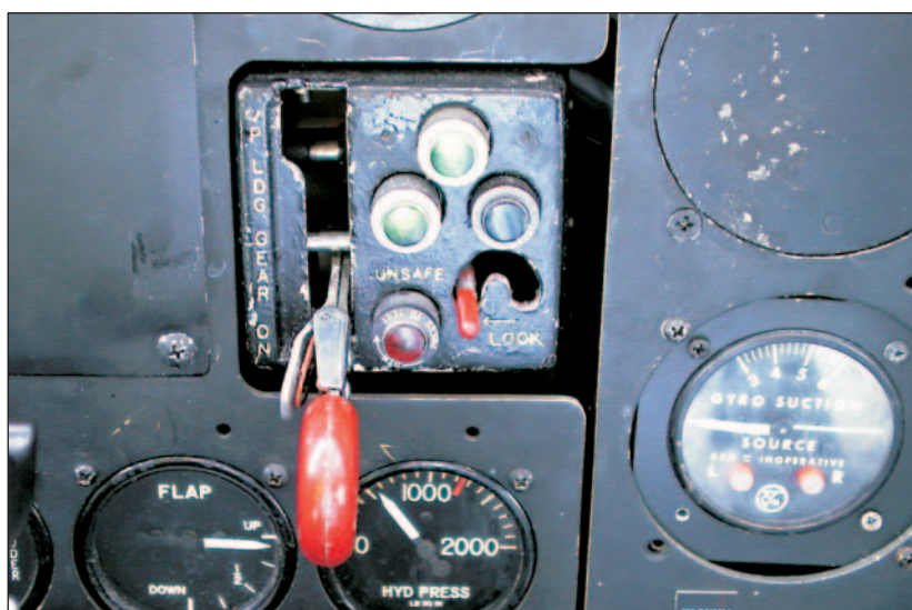
Figura 7. Mando de tren e indicadores luminosos en cabina
