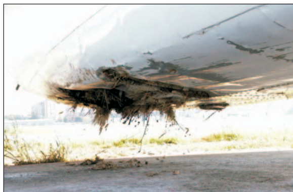
Figura 4. Detalles de daños del fuselaje
