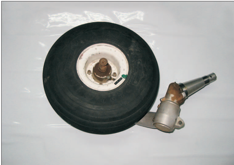
Figura 1. Elementos de la pata de morro que se desprendieron durante el despegue
